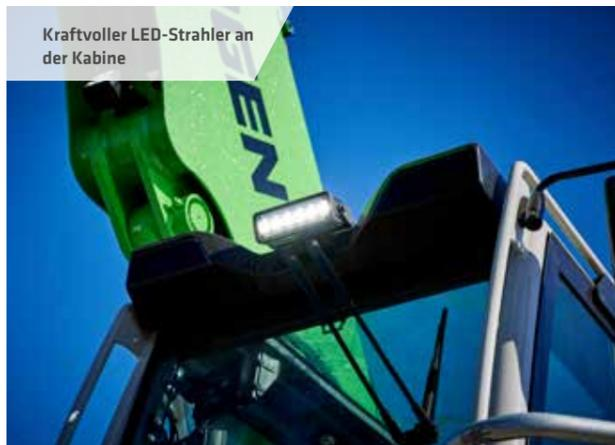
Kraftvoller LED-Strahler an der Kabine
