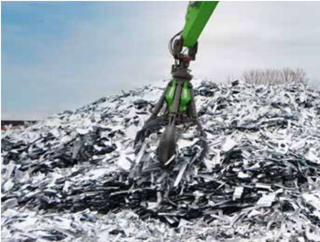
Mehrschalengreifer (SGM), Schalenform halboffen, für z. B. Blechabfälle
