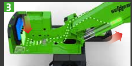
3 Nahezu konstante Kraft über den gesamten Zylinderweg unter- stützt den nächsten Hebevorgang
