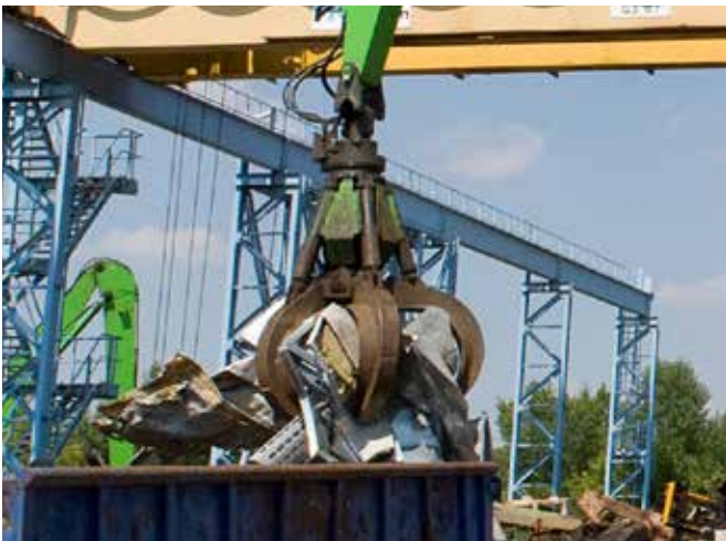
Mehrschalengreifer (SGM), Schalenform halboffen, für z.B. Mischschrott
