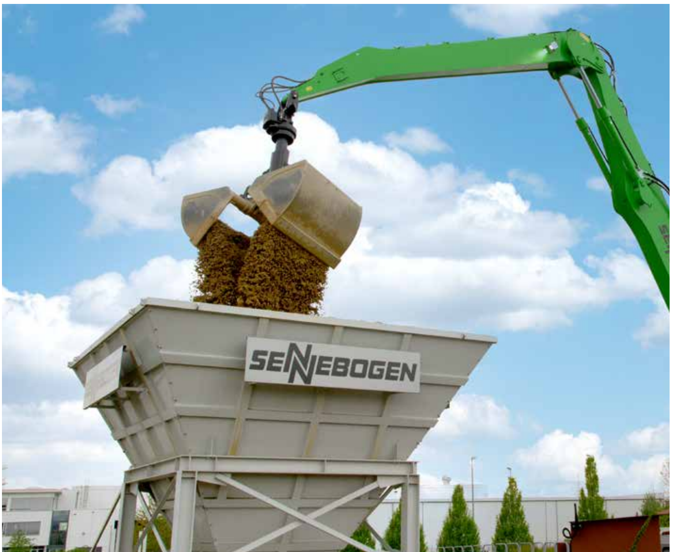
Schüttgut (Futtermittel, Kohle, etc.) mit Zweischalengreifer (SGZ)
