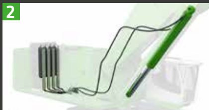
2 Energie-Speichermodule bestehend aus Hydraulikzylinder und Stickstoff- speicher
