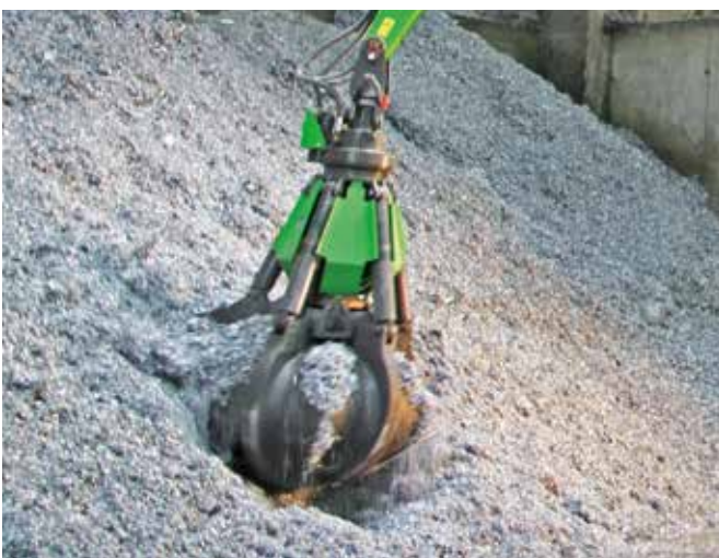
Mehrschalengreifer (SGM), Schalenform geschlossen, für z. B. Metallspäne
