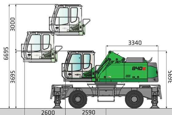
840 M avec cabine à relevage et avancement hydrauliques de type E300/260
