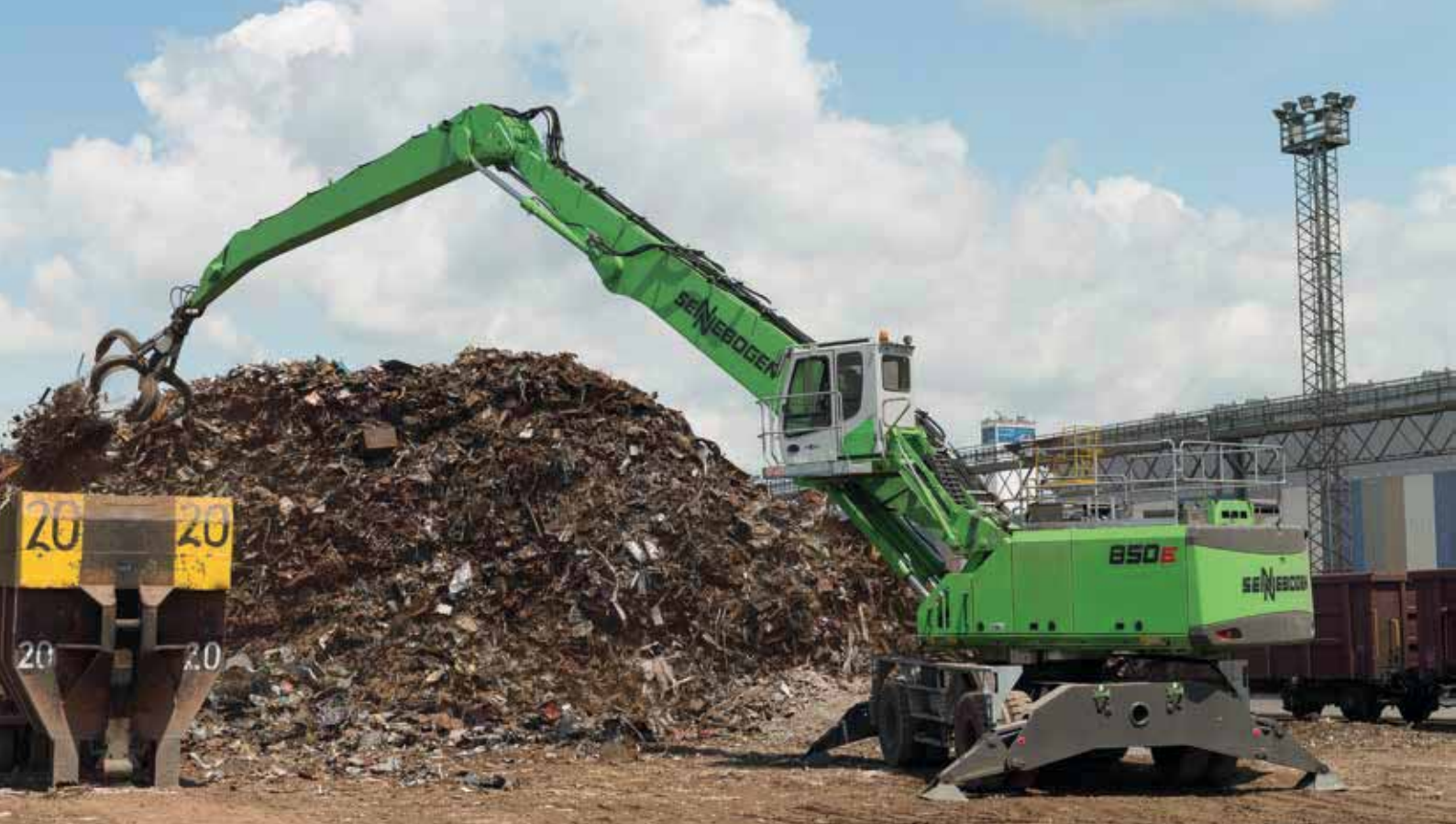
850 M - mit Mehrschalengreifer - Schrottschlag; Österreich
