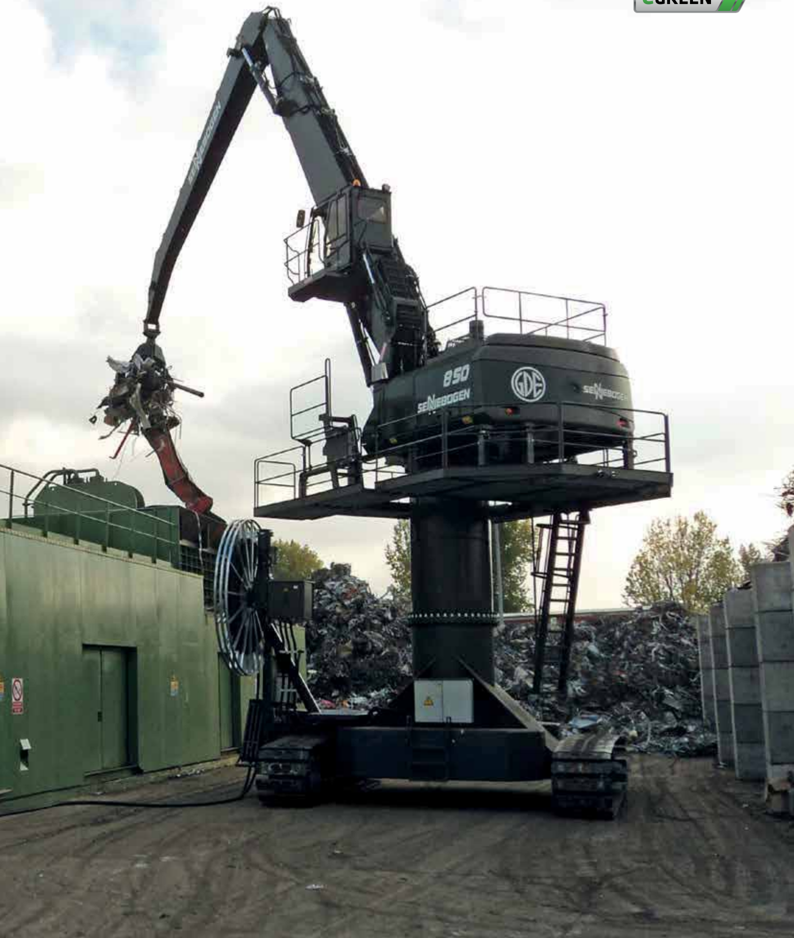
850 R Spezial Elektro mit Mehrschalengreifer - Beschickung einer Schrottschere; Frankreich
