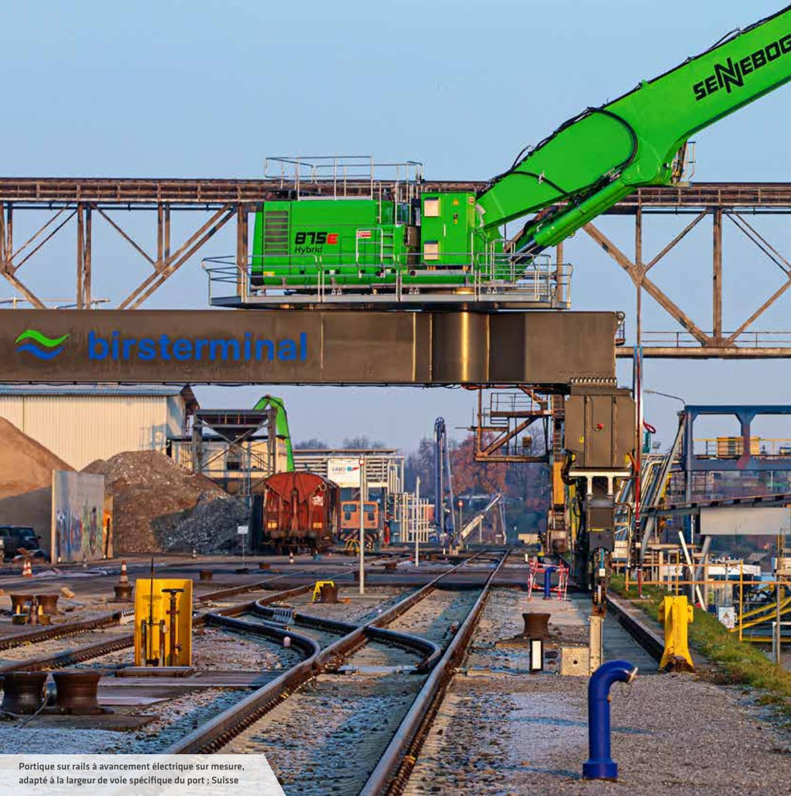
Portique sur rails à avancement électrique sur mesure, adapté à la largeur de voie spécifique du port ; Suisse
