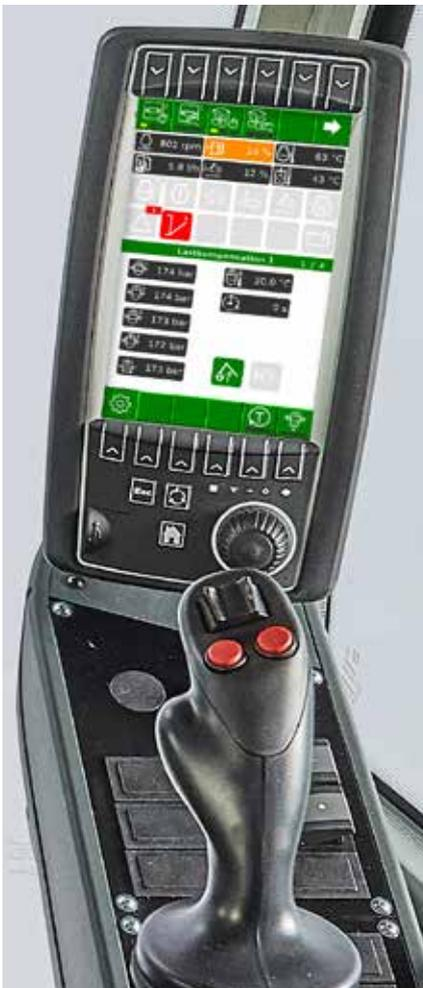
Le système de commande SENCON vous assiste pour établir le diagnostic et facilite le dépannage. Votre engin est rapidement à nouveau opérationnel.
