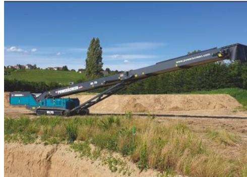
Rehausse de trémie 700 mm, syst. de pesage de bande transporteuse Pfreundt, moteur T4f avec DPF monté, capacité de transport max. 600 t/h, hauteur de déversement max. 9.8 m
