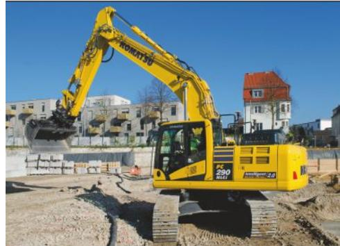
Cabine chauffage/clima, flèche mono, patins triple arrête 600 mm, attache rapide HS25DL, godet talutage, godet rétro, IMC 2.0 (3D), graissage centrale, ligne retour libre
