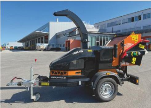
Attelage de remorque, essieu à ressort, frein à inertie, roue d'appui, moteur à essence 27 kW, trémie d'alimentation, rouleaux d'introduction hydr., 2 lames de coupe, cheminée d'éjection
