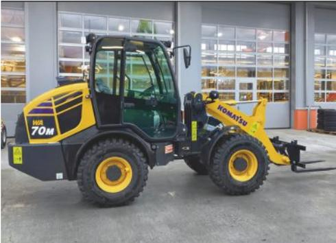
Godet 0.85 m³, sans dents, fourche à palettes, attache rapide hydraulique, entraînement hydrostatique 20 km/h, cabine inclinable
