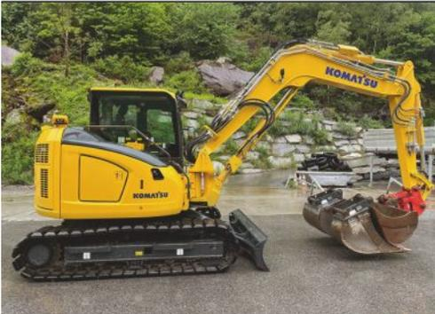
Cabine avec chauffage et climatisation, 2 circuits hydr. prop., circuit pour attache rapide, Powertilt avec MS08, patins Roadliner, balancier court 1650 mm, 1 godet humus, 2 godets rétro
