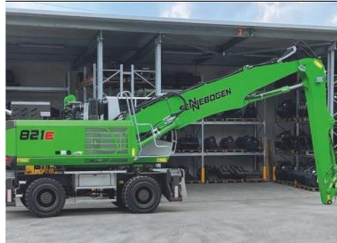
Cabine confort surélevée chauffage/clima autom., équipement K11 ULM, grappin SGR-1000, pôle de démarrage externe, SENtrack, pneus pleins, vitre de toit en verre blindé, 3 LED sur le balancier et la flèche
