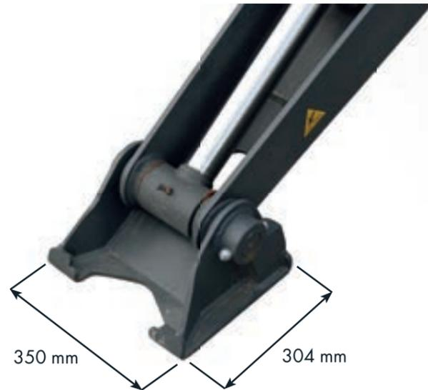
Durch die automatische Stützenkalibrierung in Verbindung mit den großen Abstütztellern ist es dem Bediener möglich sich auf nahezu jedem Untergrund abzustützen
