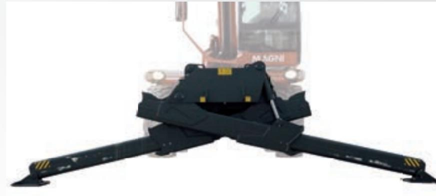
Scherenstützen befinden sich im eingefahrenen Zustand innerhalb der Fahrzeugkontur, und beeinträchtigen nicht die Bodenfreiheit. Ihre überkreuzten Stahlrohre wurden so am Chassis befestigt, dass die Bodenfreiheit auch bei austeleskopierten Stützen erhalten bleibt. Um sich den Bodenverhältnissen anzupassen können alle Stützen simultan als auch einzeln angesteuert und bedient werden.
