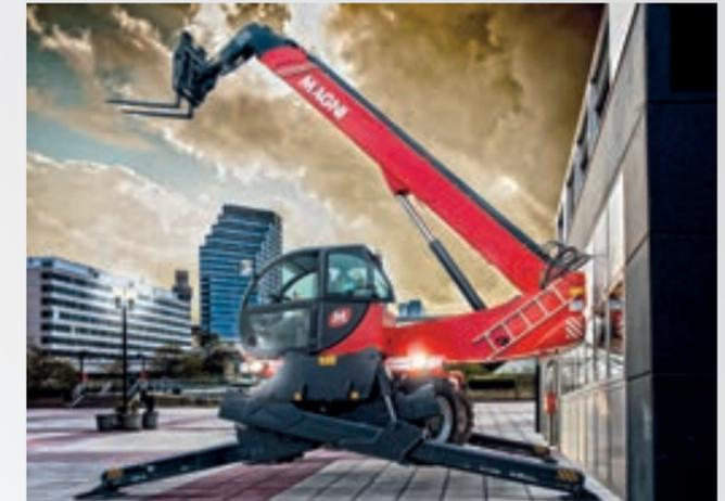
Um ein leichtes und sicheres Arbeiten zu gewährleisten ist der Drehkranz mittig auf dem Unterwagen montiert.
