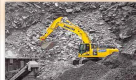
Komatsu Bagger HB365LC-3 mit Hybridantrieb, 36 to Betriebsgewicht
