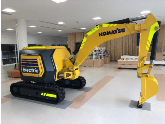
Vollelektrischer Minibagger als Konzeptmaschine für die nächste Generation von Baumaschinen
