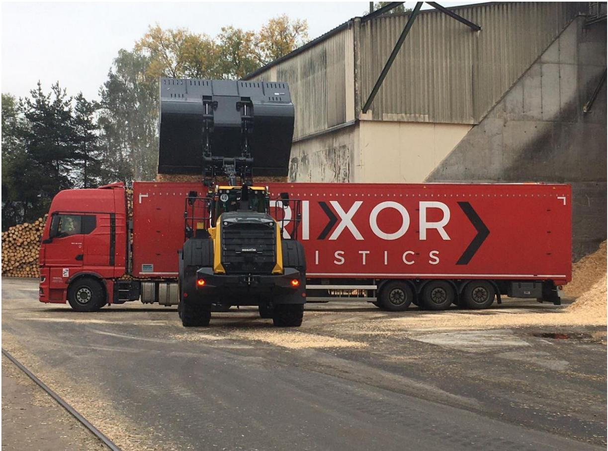
Der Industrie-Radlader WA475-10KTL von Komatsu verlädt Sägespäne in der tschechischen Stora Enso-Niederlassung in Plana.
