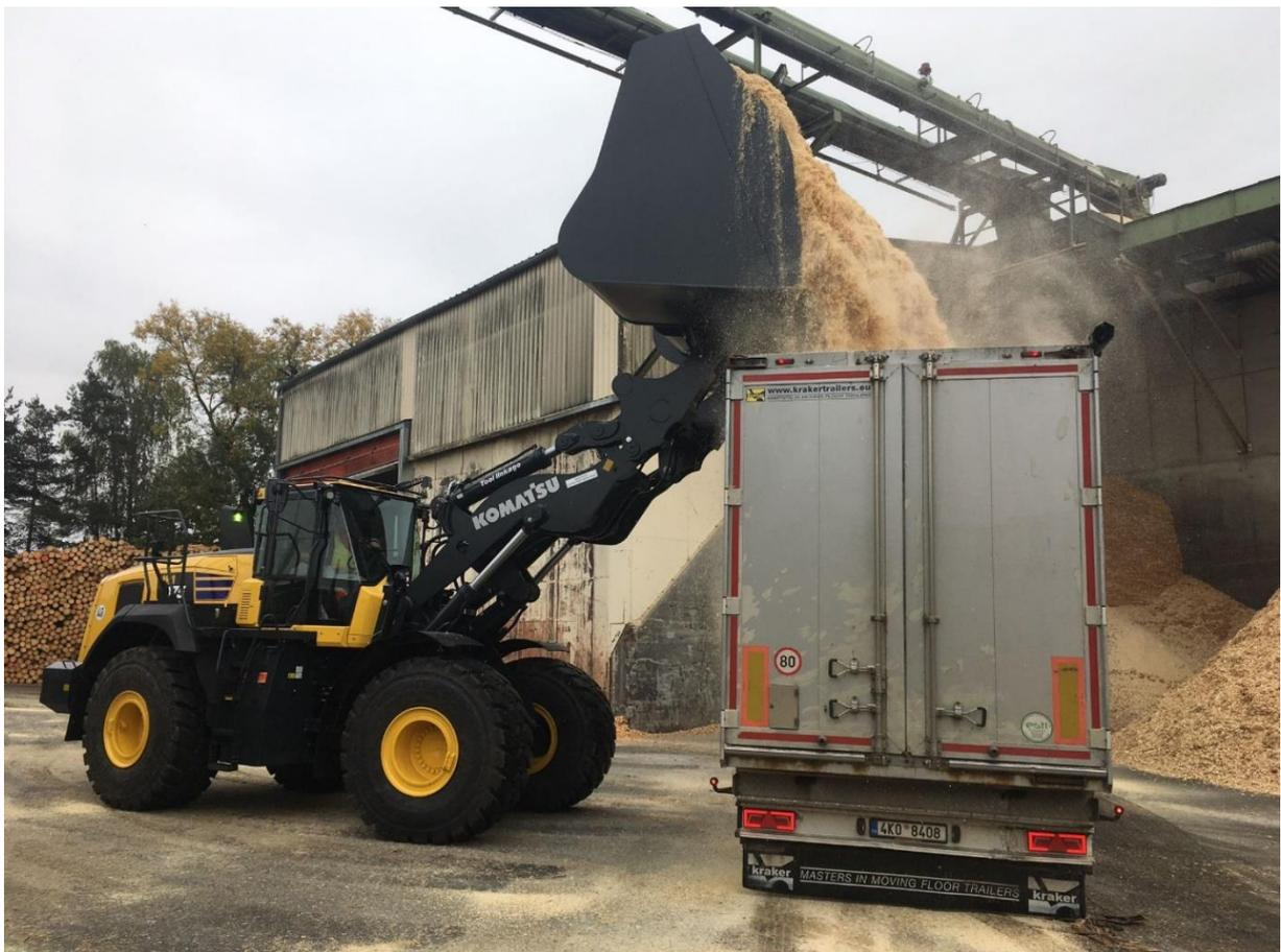
Das neu entwickelte Industrierhubgerüst eignet sich besonders für den Einsatz von großvolumigen Schaufeln und Holzgreifern.
